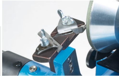
Couteau en carbure avec meule diamantée
